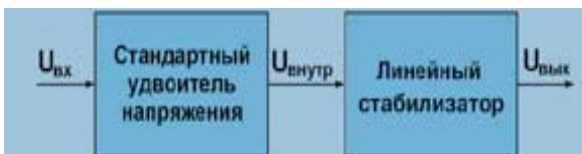
Рис. 1. Эквивалентная схема управляемого преобразователя напряжения с коммутируемыми конденсаторами
